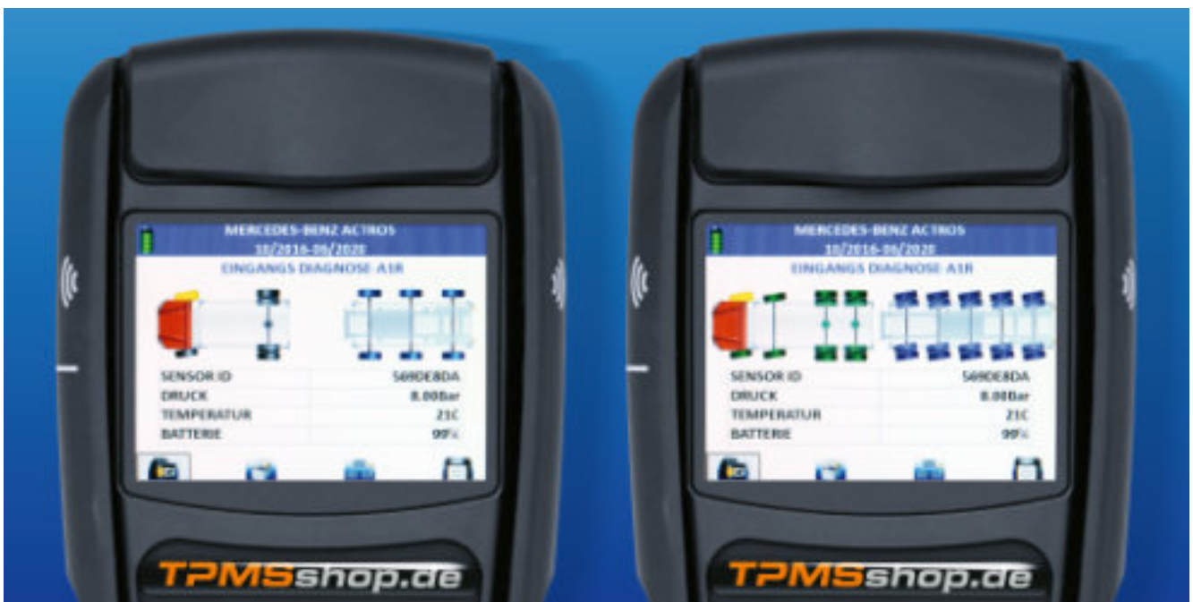
Bild 2: Über 70 verschiedene Achskombinationen für Zugmaschinen und Trailer lassen sich im Sensor AID 4.0 einfach auswählen. Durch die übersichtliche Darstellung auf dem gut lesbaren Display, weiß der Benutzer immer, für welches Rad er gerade Daten erfasst.
