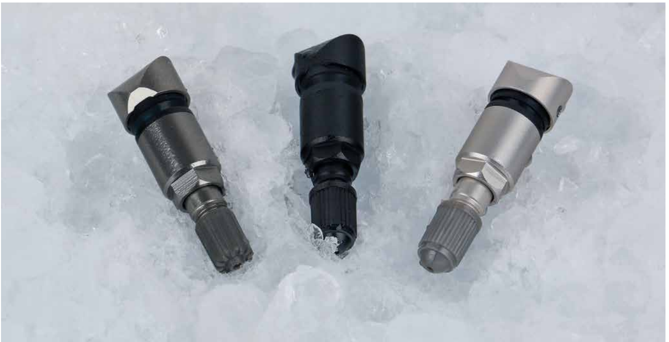
Bild 1: Die speziell beschichteten Aluminiumventile der CUB UNI-Sensoren sind in den Farben silber, schwarz und grau (v.r.n.l.) erhältlich und dank der vergüteten Oberfläche auch für härteste Winter gerüstet.
